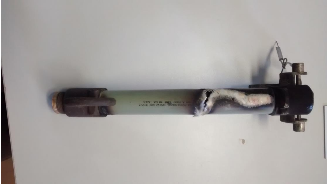
Figura 02 – Corpo de fibra de vidro da chave fusível danificado.
