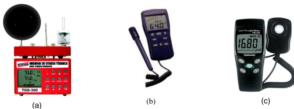
Figura 1 – Ilustrações de equipamentos utilizados: (a) Medidor de stress térmico digital Instrutherm TGD-300; (b) Termo-higrômetro digital Homis MOD 244 e (c) Luxímetro Tenmars TM-202.
